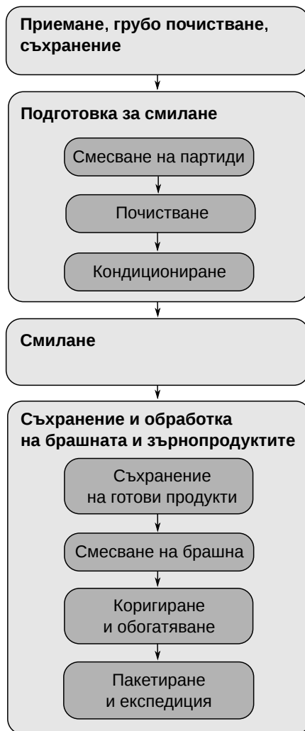
Фигура 7.1.: Схема на основните технологични операции при производството на брашна.
