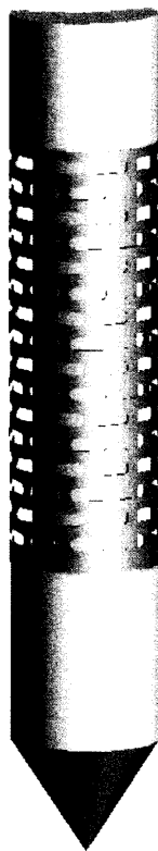
Фиг.1. Уловка за откриване на вредители в зърнена маса Fig. 1. Trap for insect's detection in stored grain
